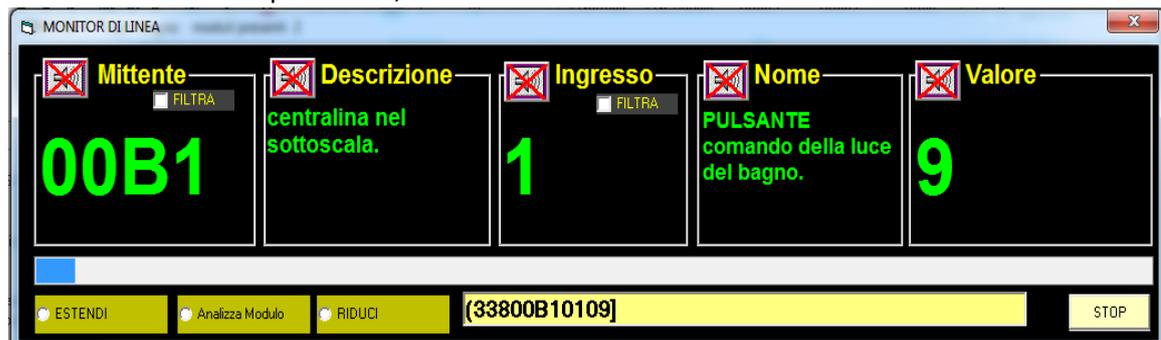
Il **codice** della centralina (00B1) e la **descrizione facoltativa** che le abbiamo assegnato (centralina del sottoscala), il **numero dell'ingresso**, la **descrizione** che abbiamo scritto sulla relativa etichetta per poterlo identificare in modo univoco ed il **valore trasmesso**.
